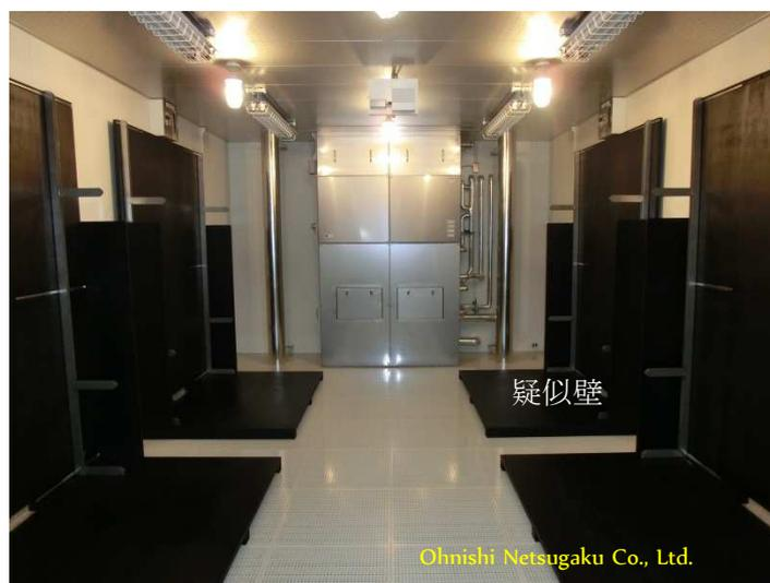
図6 冷蔵庫試験室内部と疑似壁<sup>(13)</sup>
